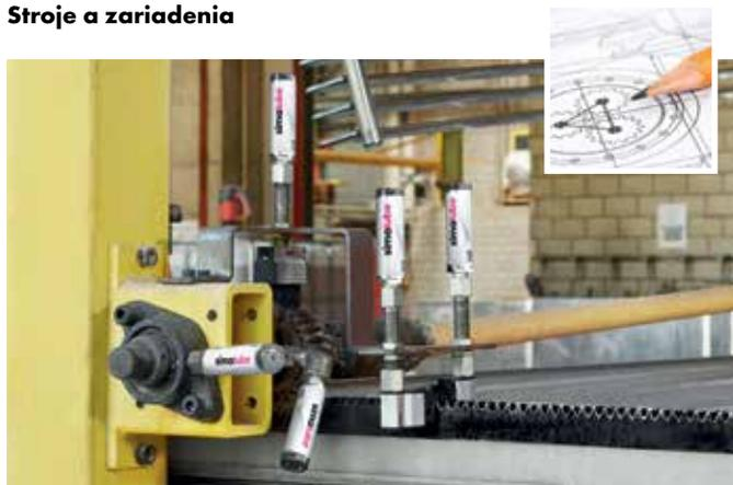
15 ml maznice simalube s kefami nepretržite zásobujú olejom stojan nakladacieho stroja. Ďalšie 15 ml maznice simalube domazávajú prírubové ložiská.
