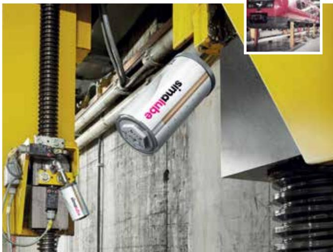
Vretená mechanického zdvíhacieho zariadenia na vagóny a lokomotívy sú spoľahlivo mazané maznicou simalube až 12 mesiacov.
