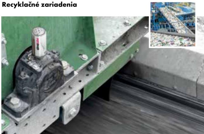
125 ml maznica simalube zabezpečuje mazanie ložiska dopravného pásového pásu.
