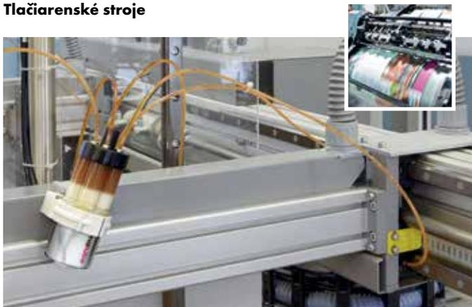
simalube viacbodový dávkovač dodáva mazivo do piatich lineárnych vodičov rezacieho a stohovacieho zariadenia v tlačiarňi.
