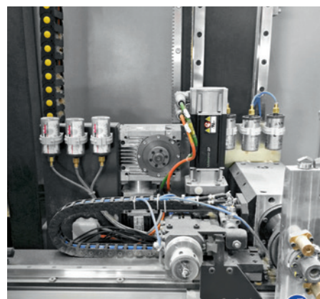
Šesť mazníc nanáša správne množstvo maziva na vodiace lišty montážneho systému.
