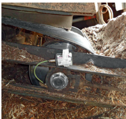
Jednotka s Y-gulôčkovým ložiskom pásového dopravníka je neprerušite zásobovaná mazivom.
