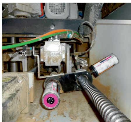
Vretno kotúčovej píly je spoľahlivo mazané pomocou dvoch mazníc simalube 125 ml.
