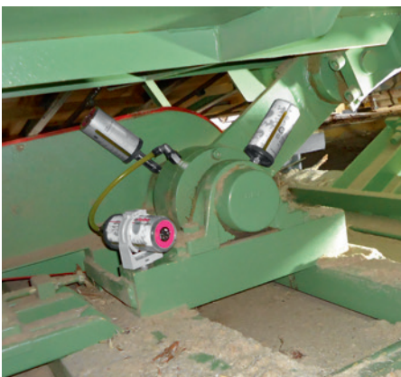
Ložiská vibračného kanála sú priebežne mazané tromi maznicami.
