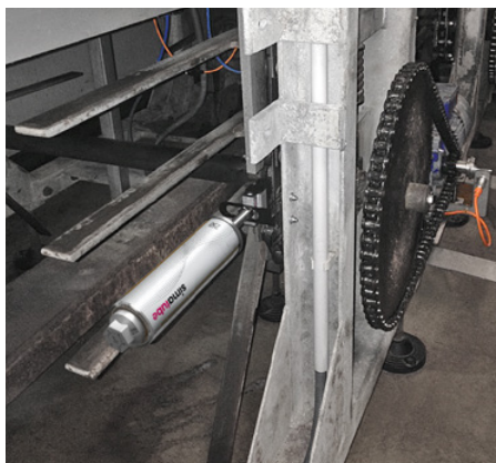
Mazanie reťaze pomocou 250 ml simalube a plochej kefy.
