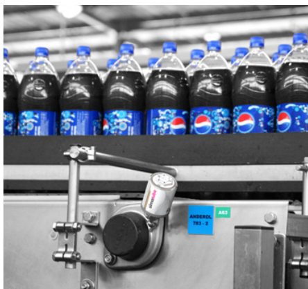
Mazanie prírubového ložiska na plnacom zariadení na nealkoholické nápoje.
