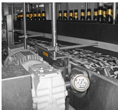
Mazanie dopravného pásu pomocou maznice simalube.
