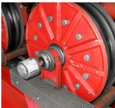
Vodiace valčeky horskej železnice sú zásobované potrebným mazivom.
